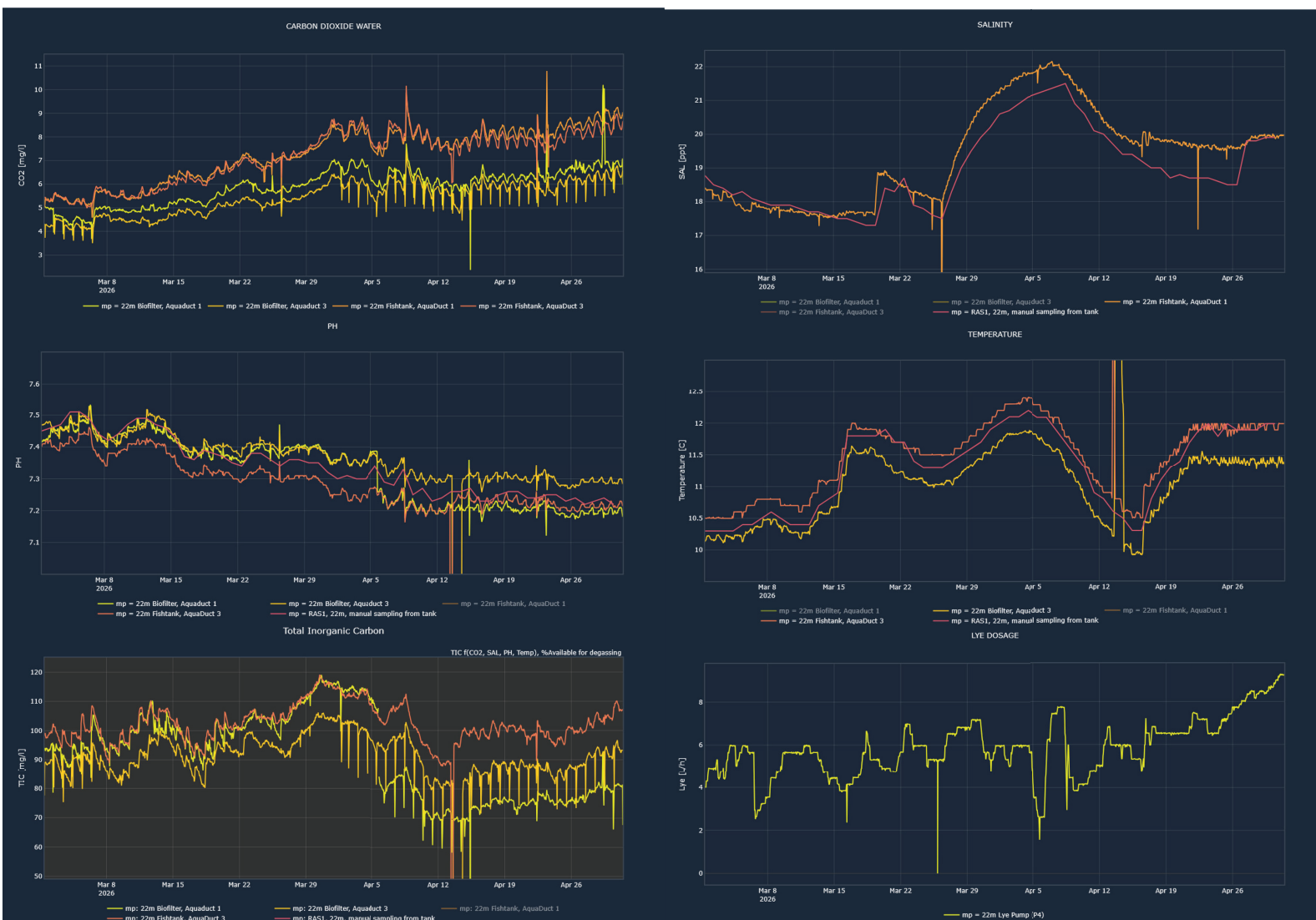
Figur 2 a+b: TIC-syntetisk sensorverdi vist i 2a og 2b; temperatur, salinitet, pH, \text{CO}_2 og lut-dosering i AquaWARE-integrity-plattformen. Karakteristiske dropp i verdier viser automatiske kalibreringer av gassensorer for å sikre korrekte målinger.
