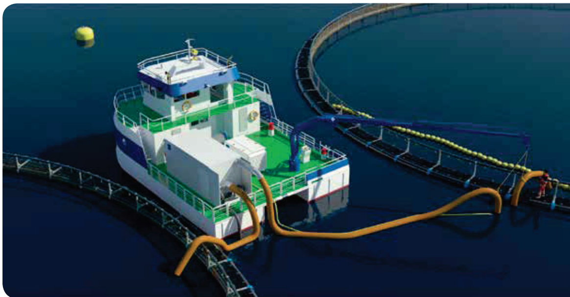
Figur 3. Thermoliceren virker ved å utsette fisk med lus for varmt vann i en kort periode. At lusa kan tilpasse seg så varmt vann som brukes i behandlingsøyemed, er derimot usannsynlig, konkluderer Sterud. Tegning: Steinsvik.
