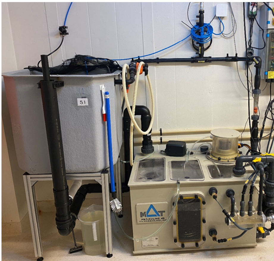
Figur 1. En av 3 identiske labskala-RAS med integrert partikkelfilter, bioreaktor, sensorer og sirkulasjonspumpe. Foto: Ole-Kristian Hess-Erga (NIVA).
