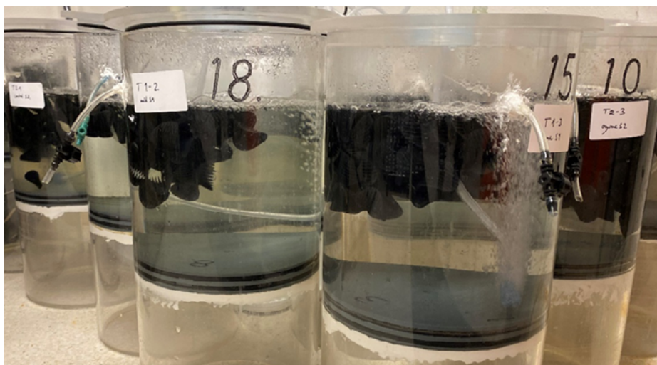
Figur 3. Små bioreaktorsystem (4 l) med biolegemer (75 stk.) fra labskala-RAS. Foto: Ole-Kristian Hess-Erga (NIVA).
